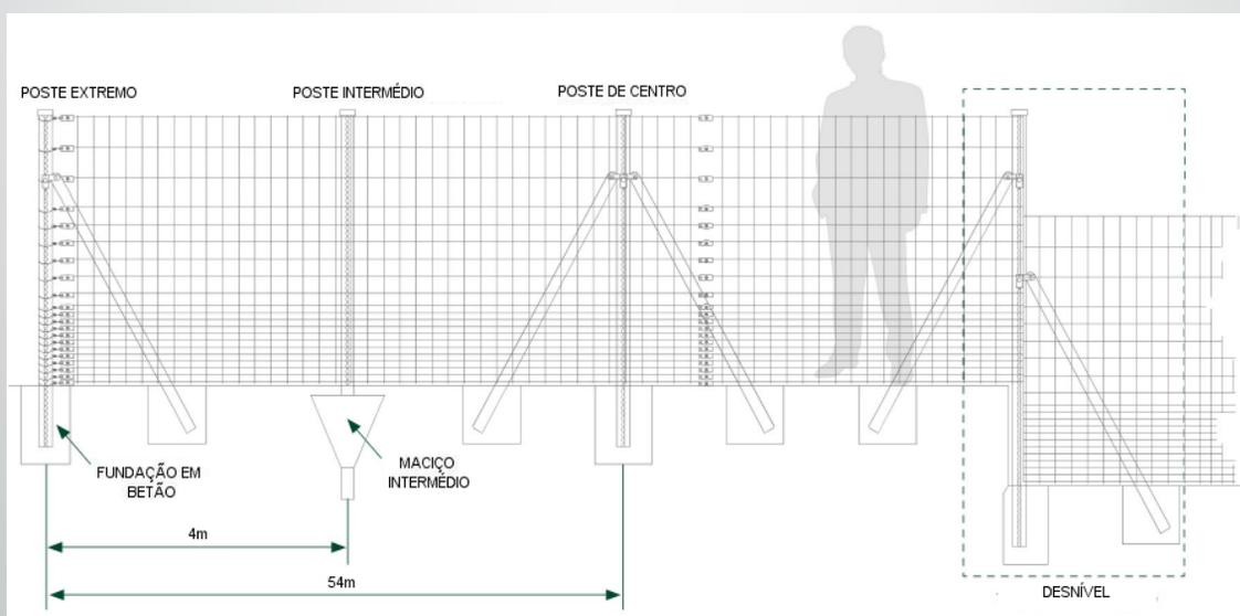
Vedação fiável e económica, ideal para grandes espaços, fabricada com malha retangular em arame de galvanização Normal a 70 gr Zn/m<sup>2</sup> e Tripla proteção a 240 gr Zn/m<sup>2</sup>, com as tolerâncias de acordo com a Norma Europeia EN 10218-2.
